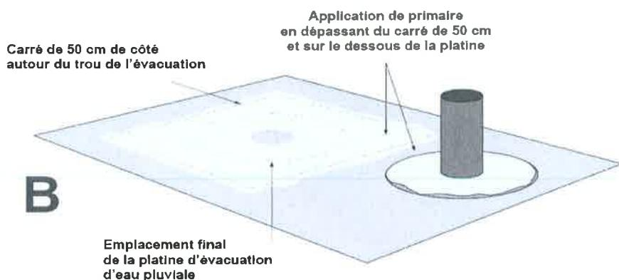
Rentrer le tube de la platine dans le tuyau de descente puis maroufler la manchette de la platine.
