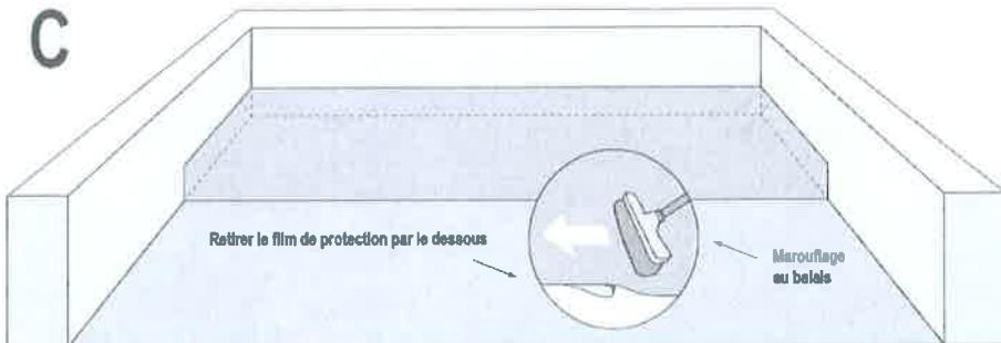
Pour les lés suivants, poser le rouleau de pare-vapeur au sol en tirant le film par le dessous et en chassant l'air au fur et à mesure avec un balai souple. Utiliser un décapeur thermique pour optimiser l'adhérence du pare-vapeur sur les relevés ainsi que sur les raccords entre lés.
