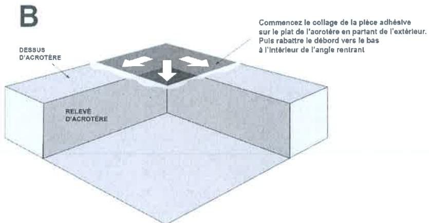
Maroufler le plat à l'aide d'une roulette plate et l'angle de l'acrotère avec une roulette d'angle. En fin de chantier, appliquer un cordon de mastic polyuréthane sur la périphérie des pièces adhésives afin d'éviter tout risque de rétractation de la bande adhésive sur les bords.
