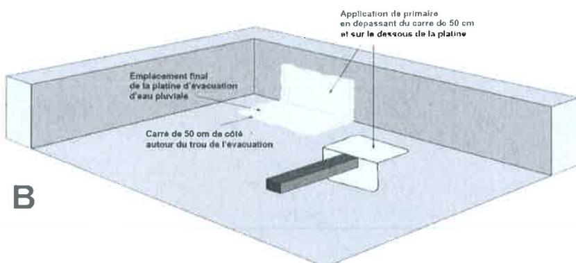
Rentrer le tube rectangulaire ou carré de la platine dans le trou de l'acrotère en pinçant les 2 «lames» de la platine pour éviter qu'elles ne collent au primaire appliqué sur la membrane. Une fois le tube totalement rentré, relâcher d'abord la «lame» du bas sur la partie courante puis la lame du haut sur l'acrotère. Maroufler à plat à l'aide d'une roulette et maroufler dans l'angle du pied d'acrotère avec une roulette d'angle.
