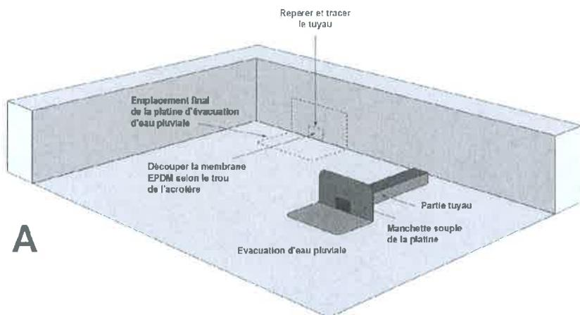
Pour les membranes talquées, nettoyer au préalable les zones avec du nettoyant EPDM-TPO. Appliquer du primaire en dépassant de 3 cm de l'emplacement de la future pièce adhésive de 45 x 45 cm ainsi que sur le dessous de la platine.
