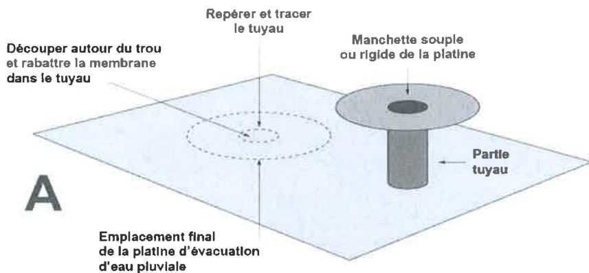
Pour les membranes talquées, nettoyer au préalable les zones avec du nettoyant EPDM-TPO. Appliquer du primaire en dépassant de 5 cm de l'emplacement du futur carré de 50 x 50 cm ainsi que sur le dessous de la platine.
