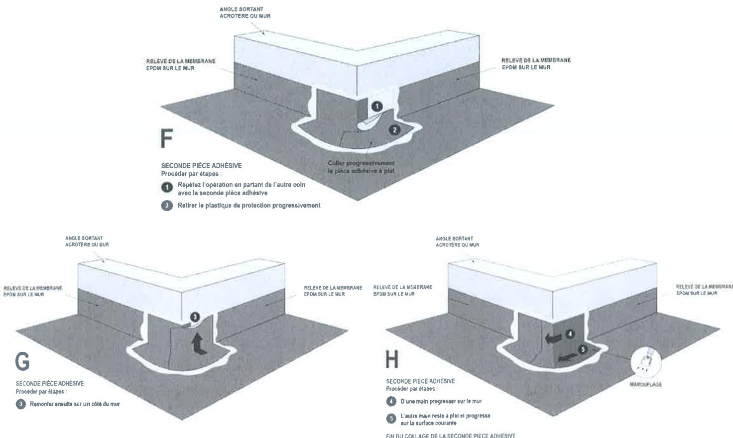
En fin de chantier, appliquer un cordon de mastic polyuréthane sur la périphérie des pièces adhésives afin d'éviter tout risque de rétraction de la bande adhésive sur les bords.
