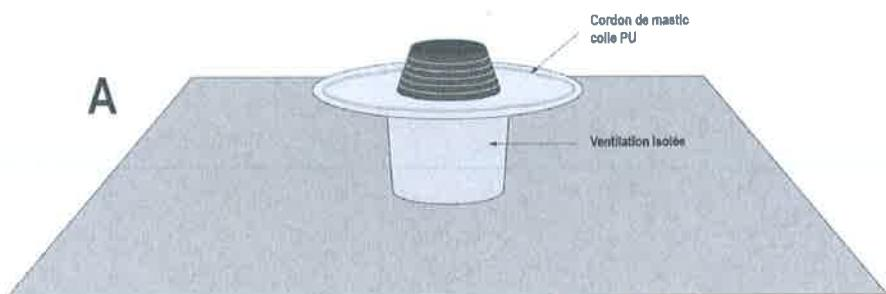
Retourner la sortie de ventilation et poser la platine à l'endroit prévu en emboitant la base de la sortie de ventilation dans le conduit.
